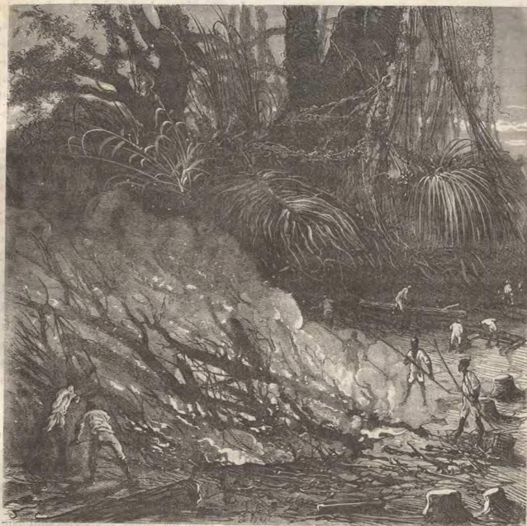
Fig. 339. — Combustion du bois et des branchages dans une forêt d'Amérique, pour recueillir les cendres et en extraire la potasse.
