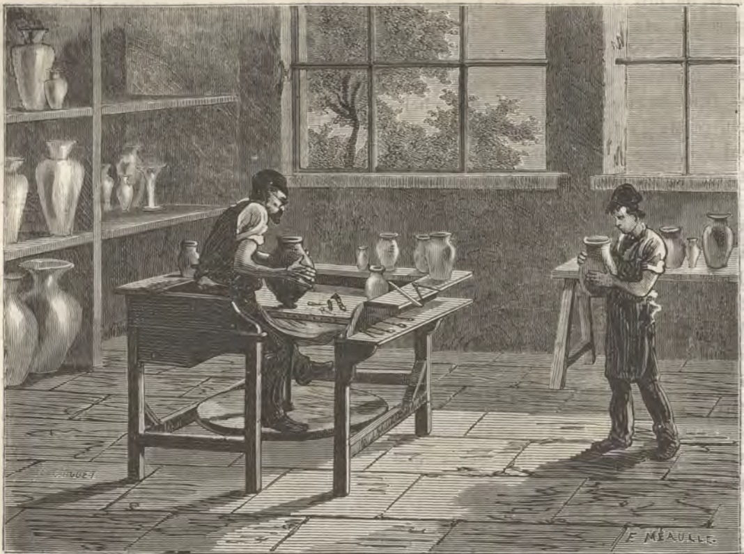
Fig. 234. — Tour du potier. — Tournassage des poteries.
