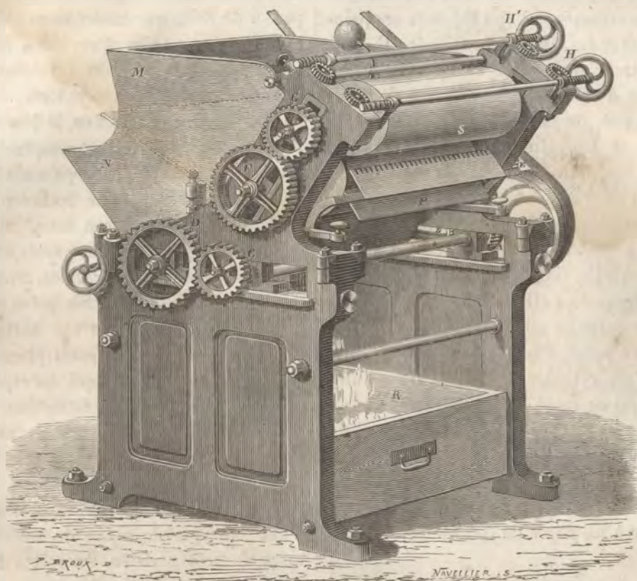
Fig. 318. — Broyeuse-mélangeuse pour la fabrication des savons de toilette.
