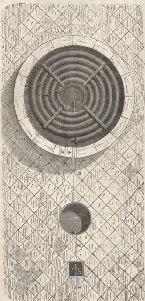
Fig. 284. — Plan de la chaudière et du serpentín pour le chauffage par la vapeur.
