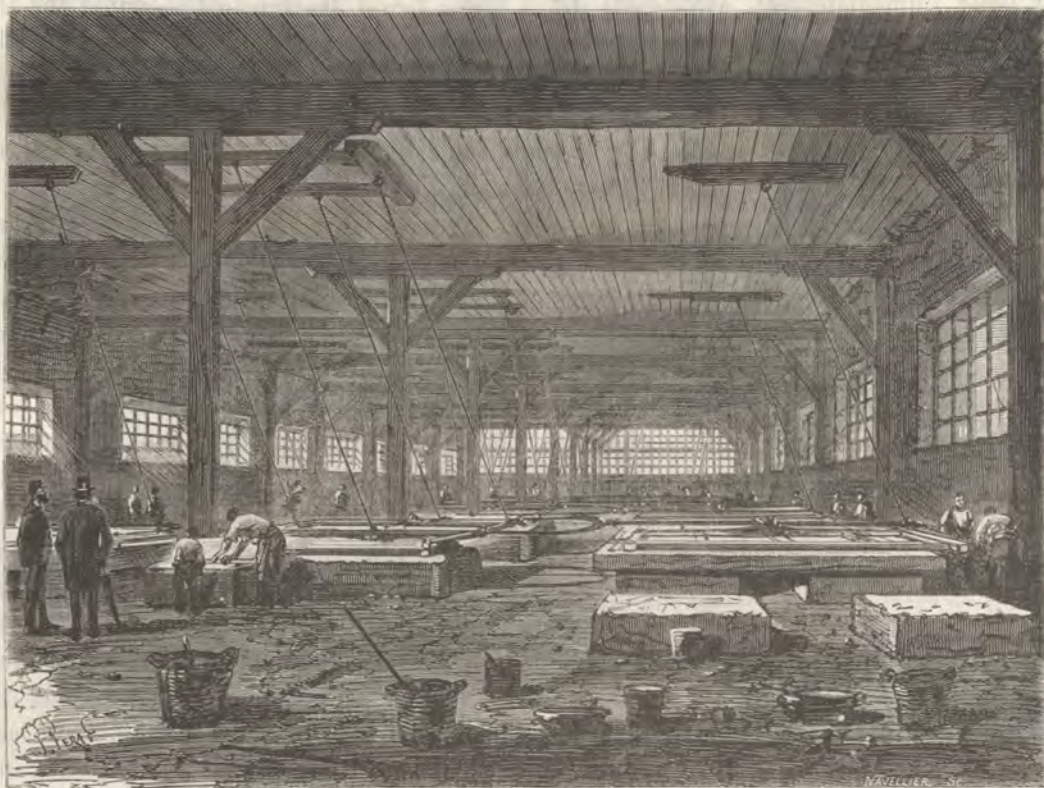
Fig. 51. — Opération du doucissage des glaces.
