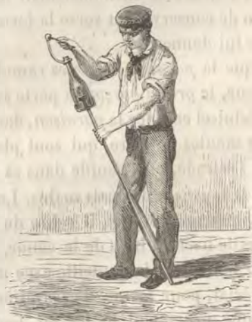
Fig. 46. — Façonnage du goulot de la bouteille.
