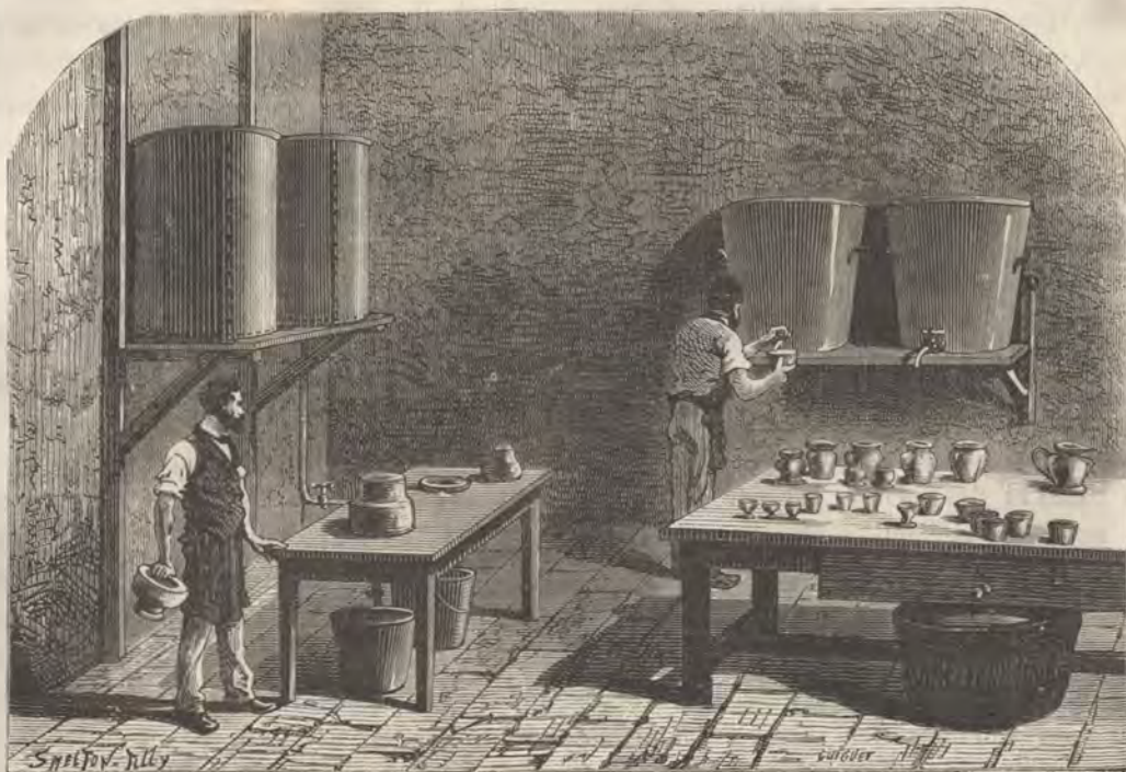
Fig. 269. — Moulage d'une pièce au moyen de la barbotine coulée dans un moule de plâtre. (Dessin pris à la manufacture de Sèvres.)
