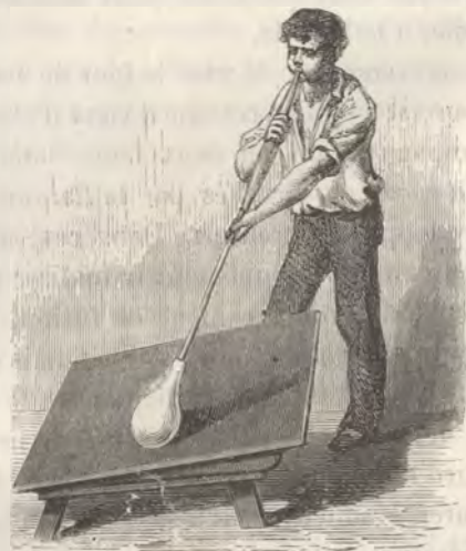
Fig. 25. — Première forme du manchon pour la fabrication des carreaux de vitres.
