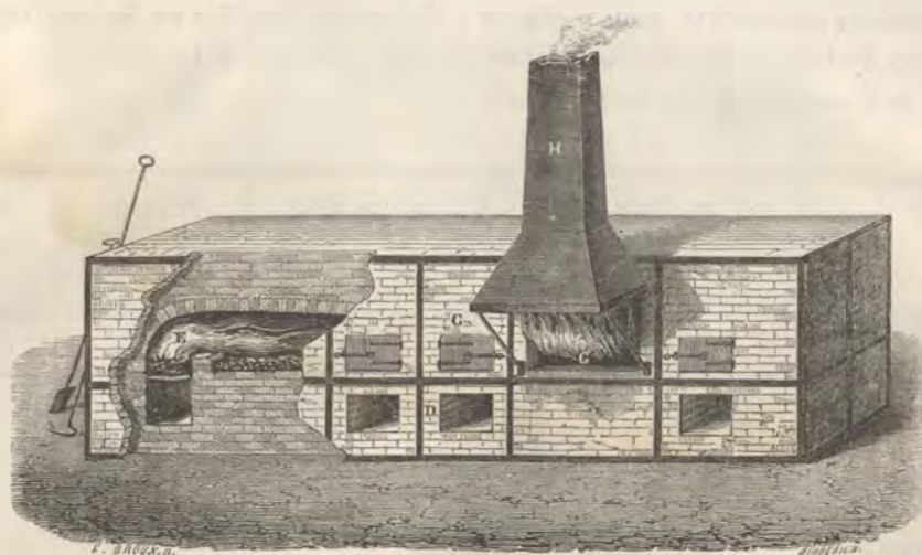
Fig 340. — Fourneau pour la transformation du salin en potasse.
