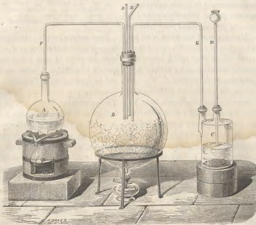
Fig. 404. — Expérience donnant la théorie de la formation de l'acide sulfurique.
