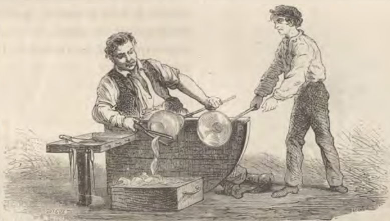
Fig. 82. — L'ouvrier rogne, avec des ciseaux, la base du verre à pied.
