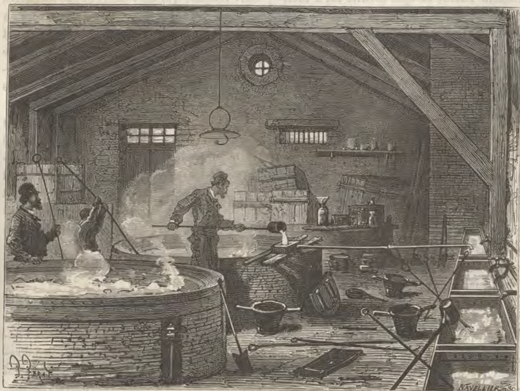
Fig. 300. — Fabrication du savon de suif dans une usine des environs de Paris. (Opérations de la coction du savon et du coulage dans les mises.)
