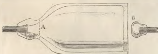
Fig. 75. — Fabrication d'un verre sans pied : formation du cylindre.
