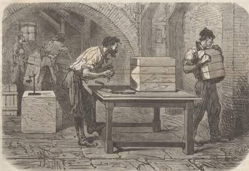
Fig. 296. — Coupe d'un pain de savon de Marseille en barres, au moyen d'un fil de fer.
