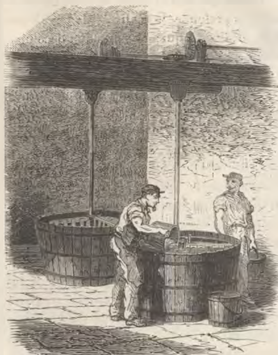
Fig. 266. — Tonneau malaxateur pour le mélange des terres à la manufacture de Sèvres.
