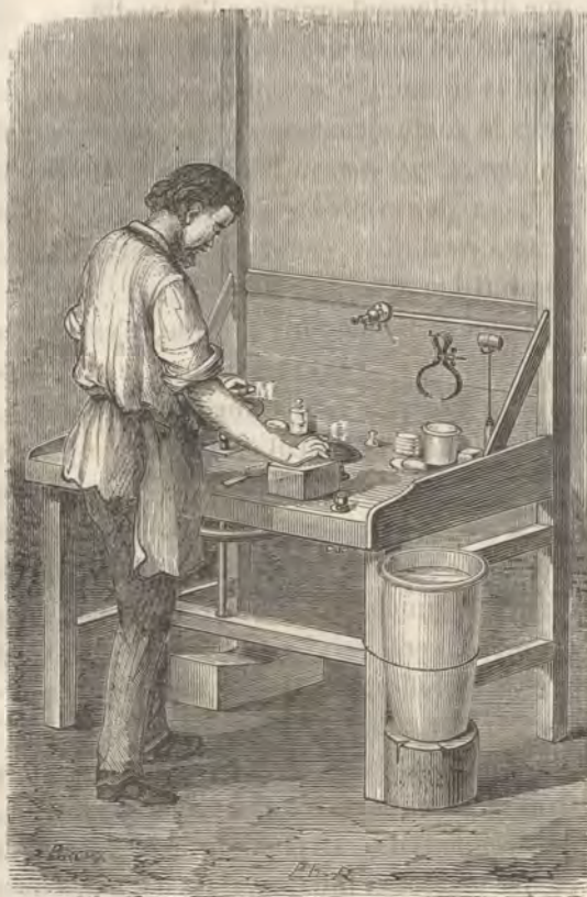
Fig. 100. — Établi de l'ouvrier usant les verres de lunettes.
