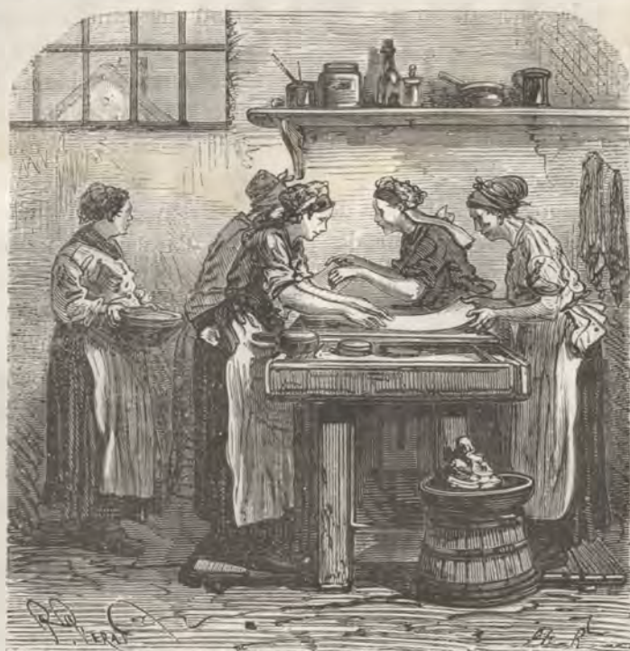
Fig. 52. — Argenture d'une glace par le procédé Drayton.
