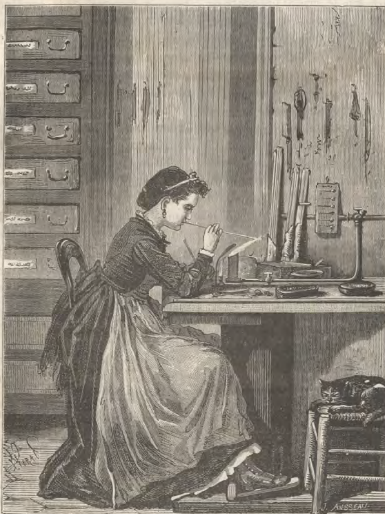
Fig. 97. — Ouvrière parisienne soufflant une fausse perle.
