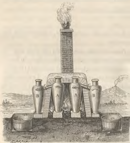
Fig. 395. — Appareil pour la distillation des terres de la solfatare de Pouzzoles.
