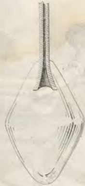
Fig. 32. — Première forme de la masse de verre pour la fabrication des carreaux de vitres par le procédé des plateaux.
