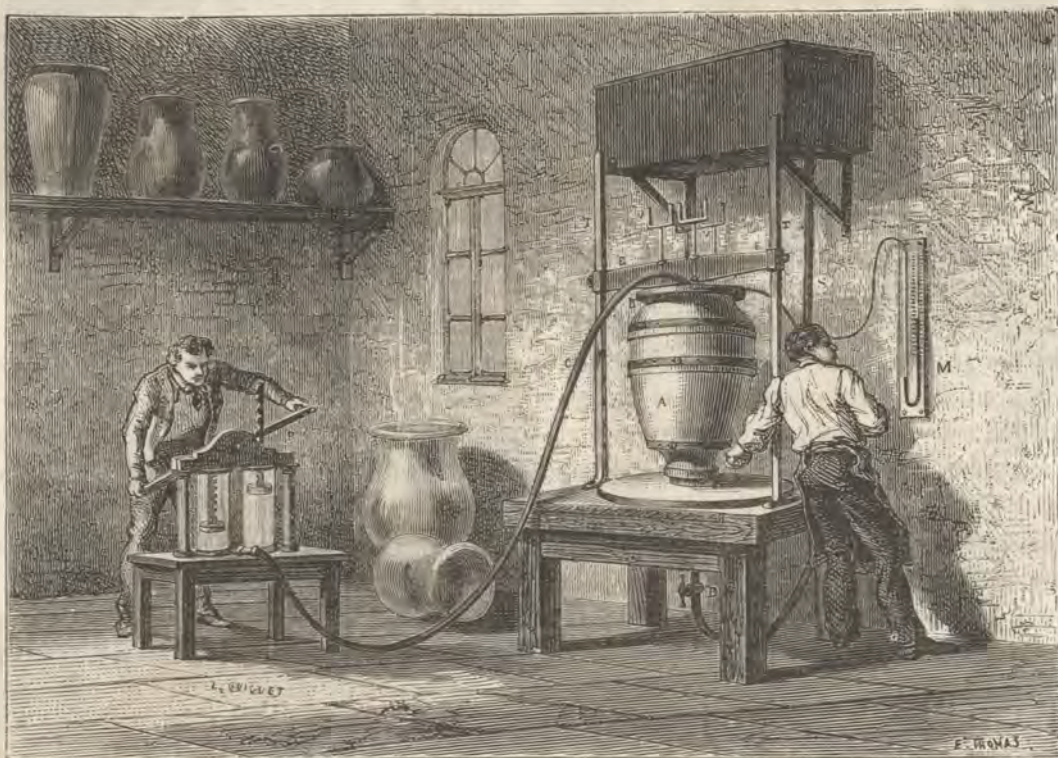
Fig. 270. — Appareil employé à la manufacture de Sèvres pour façonner les grandes pièces par le procédé du coulage avec le secours de l'air comprimé agissant à l'intérieur du moule.
