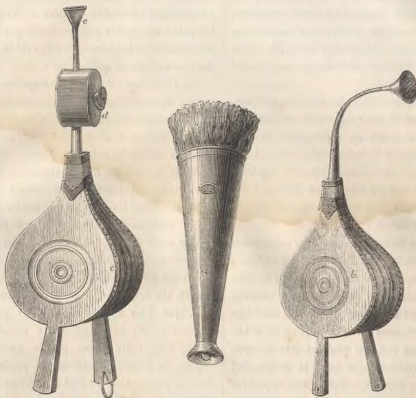
Fig. 399, 400 et 401. — Soufflets et houppe pour répandre les fleurs de soufre sur la vigne et les arbres fruitiers.
