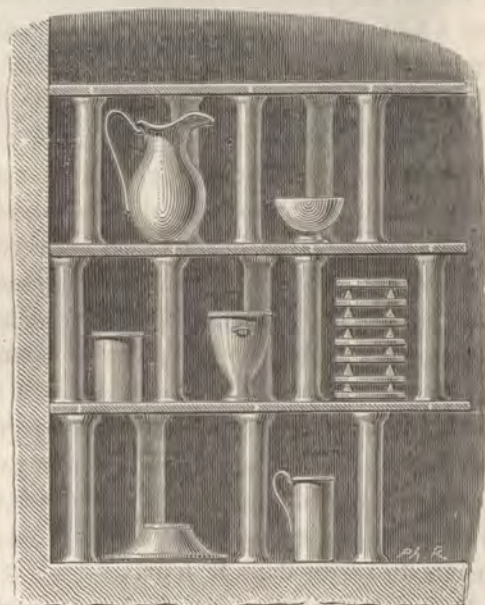
Fig. 259. — Enfournage des pièces de faïence sur des tablettes en échappade.
