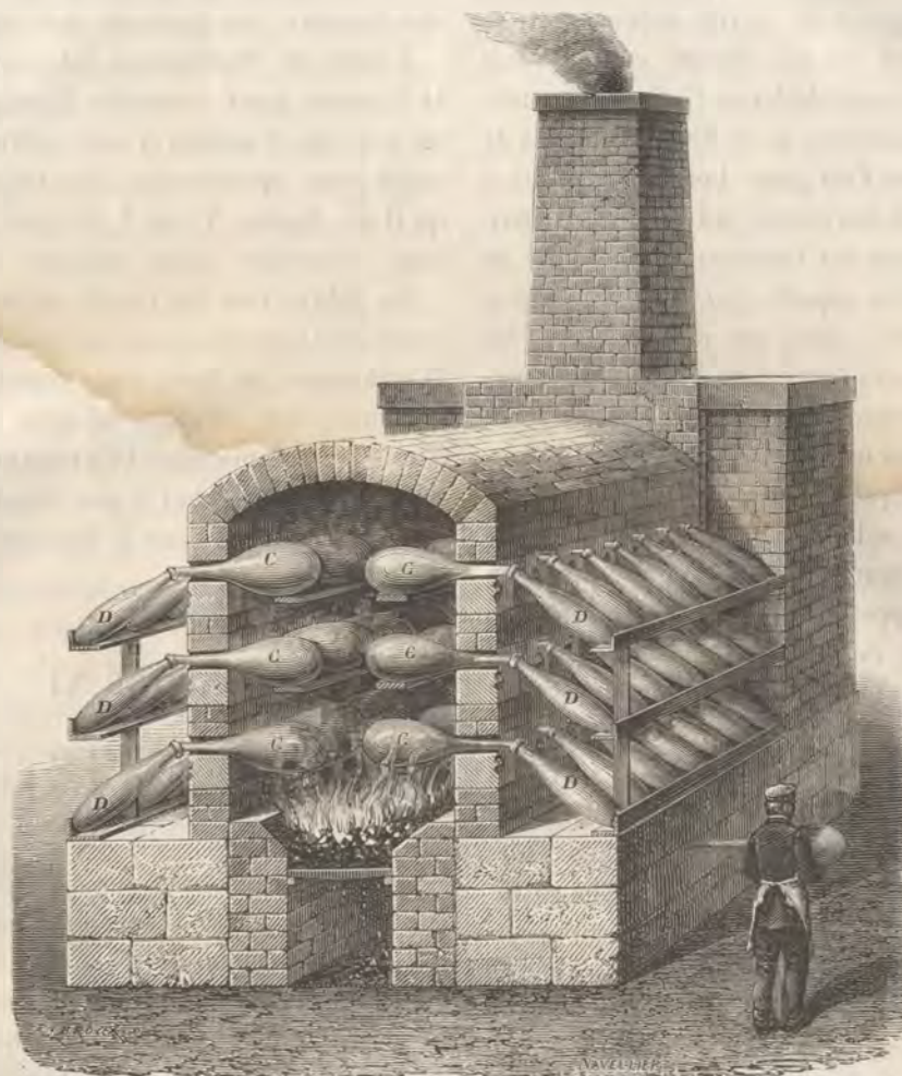
Fig. 413. — Appareil pour la préparation de l'acide sulfurique de Nordhausen.
