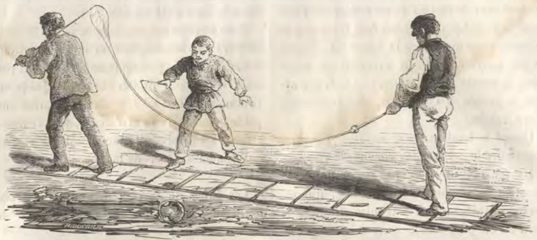
Fig. 45. — Étirage d'un tube. Le gamin refroidit à l'aide d'un éventail les parties du tube qui s'amincissent trop vite.
